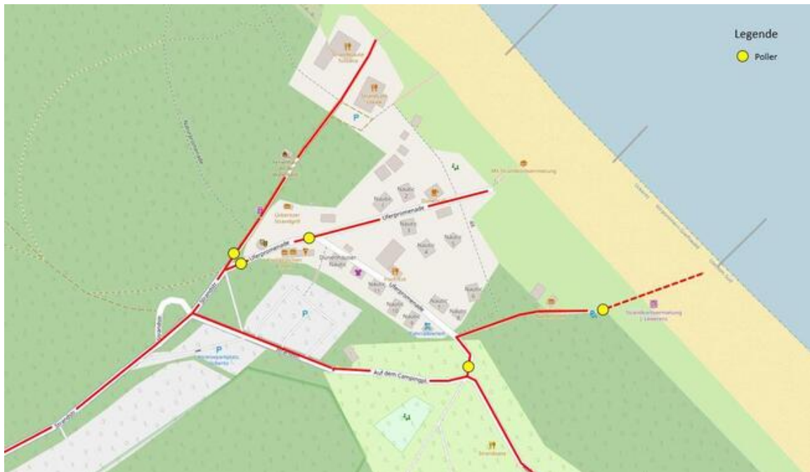
Zufahrtwege für Rettungsfahrzeuge, die im Fußgängerbereich durch Poller abgesperrt sind.
