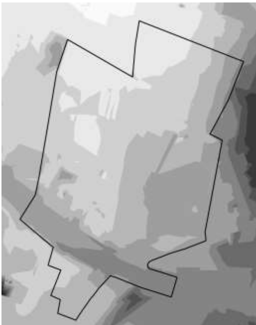
Abbildung 9: Höhengsituation im Plangebiet (Je dunkler, desto höher das Gelände.) (Quelle: IPO 2019 / 2016)
