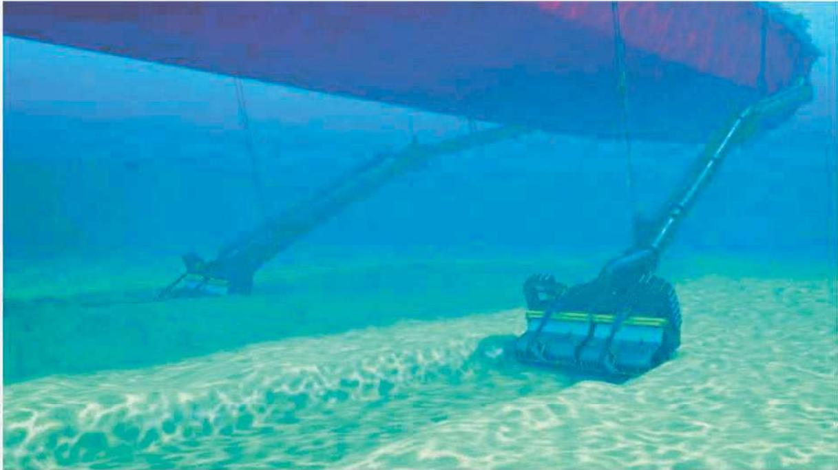
Abbildung 2: Modell und Wirkprinzip eines Laderaumsaugbaggers („Hopperbagger“)
