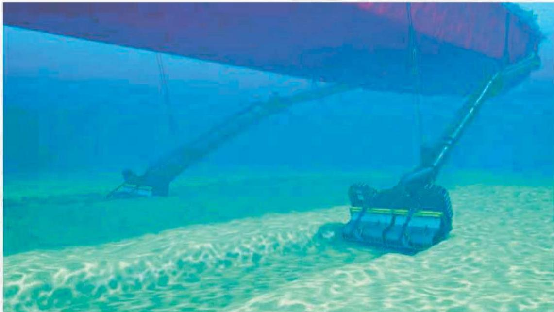
Abbildung 3: Modell und Wirkprinzip eines Laderaumbaggers („Hopperbagger“)
